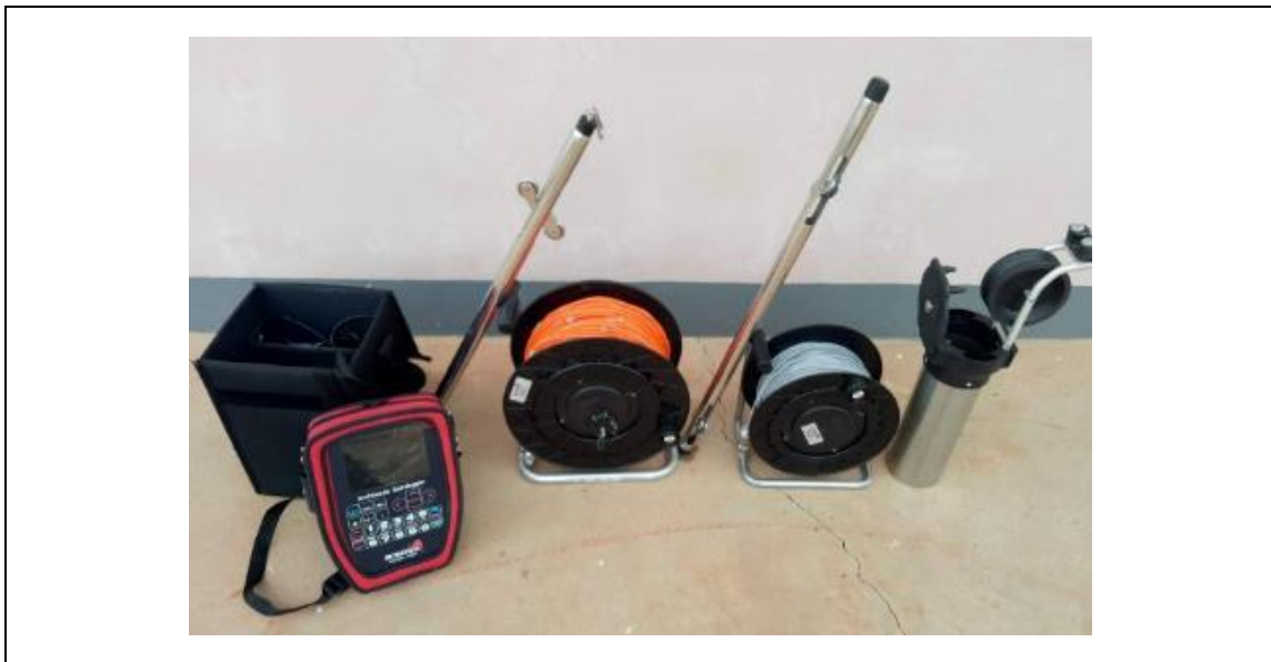
รูปที่ 3.7.2-6 อุปกรณ์มาตรวัดการเคลื่อนตัวในแนวนราบ (Inclinometer) และท่อรางที่ใช้ติดตั้งในหลุมเจาะ (Inclinometer Access Tube)
