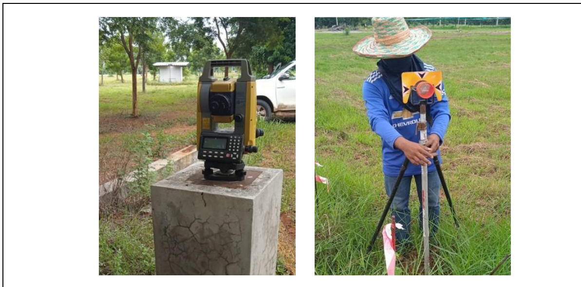
รูปที่ 3.7.1-1 การก่อสร้างหมุดหลักฐานอ้างอิง (Benchmark Point) และหมุดตรวจสอบบริเวณแนวการก่อสร้างขุดเจาะอุโมงค์แนวลาด
